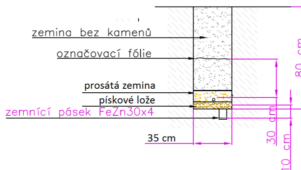
Obr.2 Vzorový řez kabelového výkopu od sloupu po společnou trasu podél kolejiště
